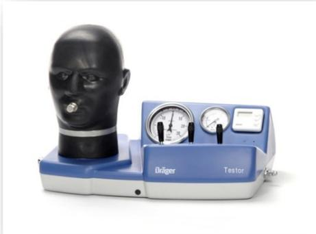
**Gerät zur statischen Prüfung**
